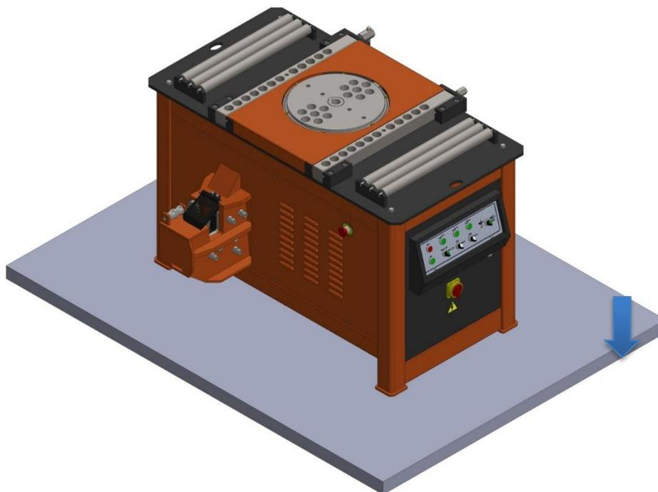
Figure 2: Positionnement de la machine sur une surface stable.
