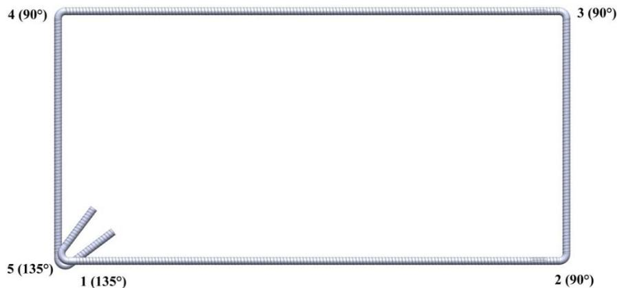
Figure 14: Réglage de la flexion des étriers
