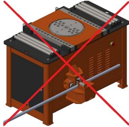
Positionnement incorrect du fer à couper sans utiliser de protection de lame lors de la coupe
